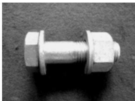
写真3 溶融亜鉛めっき高力六角ボルト
