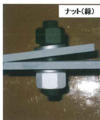
節付き両ねじ高力ボルトの本締め
